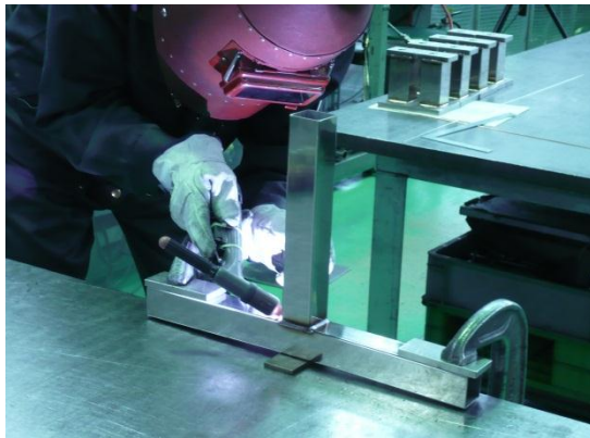
★逆ひずみ法にて溶接中
